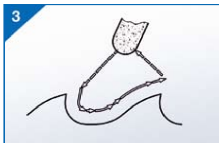
Bild 1: Schleifkopfbewegung bei Bi-Metall-Bändern
